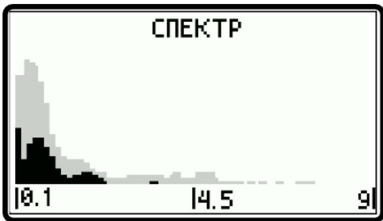
Рис. 6.5 Экран настройки спектра на бездефектном участке
