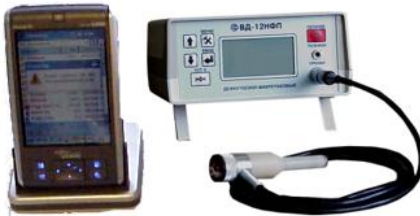
Рис. 11 Устройство НРК и дефектоскоп ВД-12-НФП.
