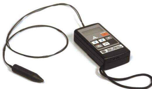
*Рис. 1 Общий вид дефектоскопа вихретокового ВД-89НП*
